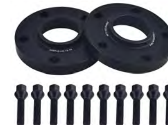
LELK020 20mm Wheel Spacer 5*120mm/72.56mm Fit BMW E30 E36 E46 E90 E91 E92 E93
