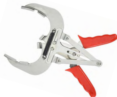
PSRT02-8 BK BL RD OG 8" Piston Ring Expander Pliers Capacity 110-160mm
